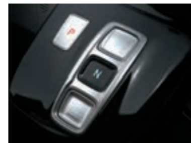
ناقل حركة كهربائي يعمل أوتوماتيكياً
