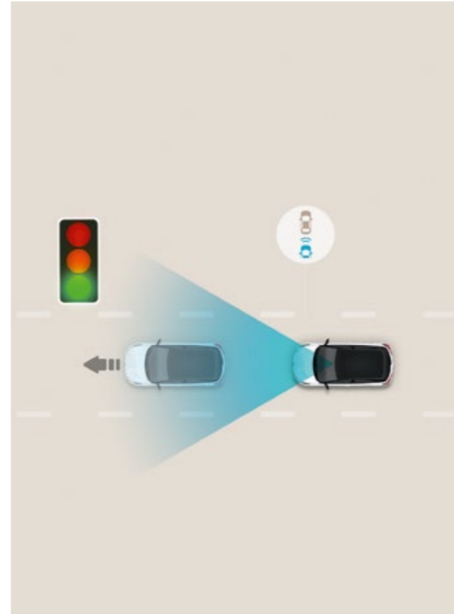
تنبيه بدء تحرك السيارة في المقدمة (LVDA) تقوم هذه الميزة الذكية للقيادة داخل المدينة بتنبيه السائق عندما تخرج السيارة التي تسبقه من حالة التوقف المؤقت عند إشارات المرور أو في الازدحام المروري.
